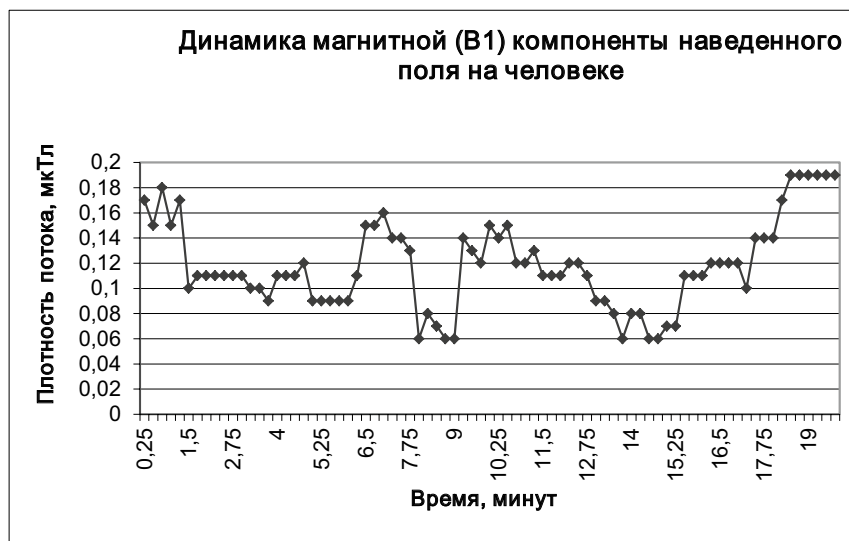
Рисунок 6. Динамика плотности магнитного потока B_1 , наведенная корректором в организме человека
