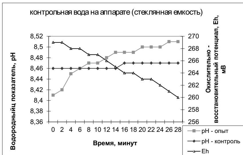
Рисунок 5. Изменение электрохимических показателей опытной воды, установленной на аппарате (стеклянная посуда, измерения без потенцирования через 12 минут после отключения аппарата, проработавшего 27 минут)
